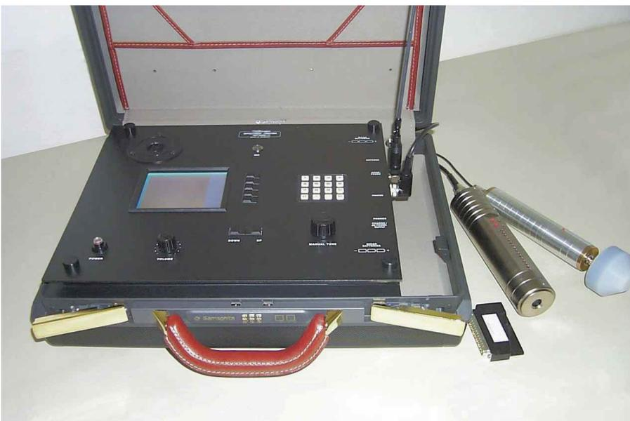
Ein in Deutschland entwickelter Lauschabwehrkoffer vereint Suchempfänger, Codetonsender, Sound-Korrelator, Bildschirm, Empfangsantennen, Handsonden, Druckerschnittstelle und Expansionsport in einem unauffälligen „Gehäuse“. Der Empfangsbereich erfasst Frequenzen zwischen 1 und 6000 MHz mit FM-, AM-, NFM-, NAM-Modulation.
