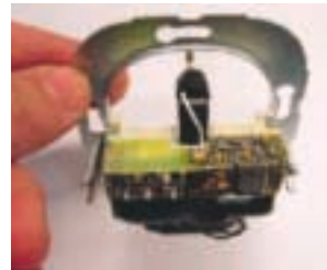
Bild 1: Einbaufertige, verwanzte Unterputzsteckdose: Die Wanze geht nur auf Sendung, wenn gesprochen wird.
